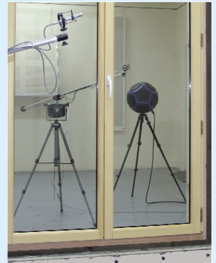
Installation des microphones
